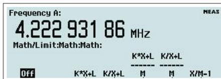
Wählen Sie eines der vier Formulare und geben die Konstanten K, L und M ein, um den Zähler direkt zu zeigen, was Sie wünschen, ohne langweilige Berechnungen. X steht für das vorliegende Messresultat. Siehe 'Operators Manual' für eine nähere Beschreibung.
