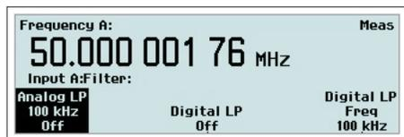
Sie können einen festen 100 kHz. Analogen Filter oder einen einstellbaren digitalen Filter wählen. Die äquivalente Abstellfrequenz wird über das Werteingabemenü eingestellt, das öffnet, wenn Sie Digital LP-Frequenz von dem Menü oben wählen.
