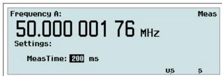
Dieses Werteingabemenü ist nur brauchbar, wenn Sie eine Frequenzfunktion wählen. Längere Messzeiten bedeuten weniger Messungen per Sekunde, aber bedingen eine höhere Auflösung. Sie können die Messzeit mittels Eingabe eines numerischen Wert ändern, oder auch den Pfeiltaster **UP/DOWN** um den gegenwärtigen Wert zu senken oder erhöhen.
