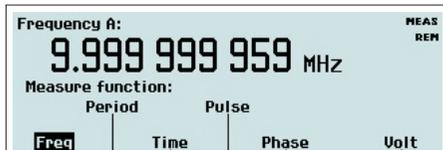
Die vorliegende Wahl wird durch Textinversion angezeigt. Wählen Sie die gewünschte Messfunktion mittels Druck auf den dementsprechenden *weichen* Taster gleich unter dem Display. Ein neues Menü wird erscheinen, auf dem der Inhalt von der Funktion abhängt. Wenn Sie vielleicht **Frequency** gewählt haben, können Sie zwischen **Frequency**, **Frequency Ratio** und **Frequency Burst** wählen. Schliesslich können Sie auch den vorgewählten Eingabekanal ändern.
